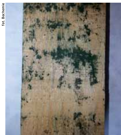
Do usuwania przebarwień zaatakowanego już drewna przez pleśń powodującą siniznę służy preparat BOCHEMIT® Przeciw Pleśni.
