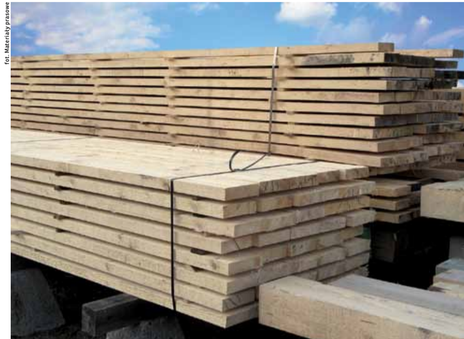
Najczęstszym sposobem zapewnienia przepływu powietrza w składowanej tarcicy jest stosowanie przekładek.
